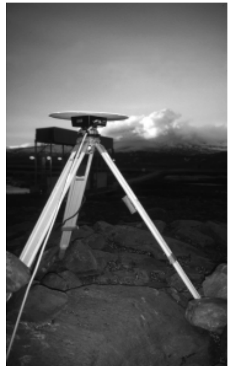
GPS-geodætisk antenne placeret over et geodætisk mærke. Mærket er en kobbernagel i stabil klippe. Antennen må være sat op præcis over mærket, for at man med gentagne målinger kan finde ud af jordskorpebevægelser så små som 5 millimeter. (Foto: Forfatteren)
